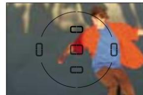
Dynamischer Autofokus: Die Kamera stellt stets auf das Motiv scharf und aktiviert automatisch ein benachbartes Fokusmessfeld, wenn das Motiv das aktuelle Messfeld verlässt.
